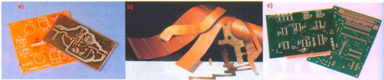
Figura 9.1 Diferentes tipos de circuitos impresos a) De una cara, b) Flexible, c) De doble cara
