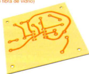
Figura 9.4 Circuito impreso terminado. El percloruro férrico se encarga de rebajar el cobre sobrante.
